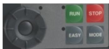
**RUN/STOP:** Usado para partir e parar o inversor quando o controle é via frontal.
