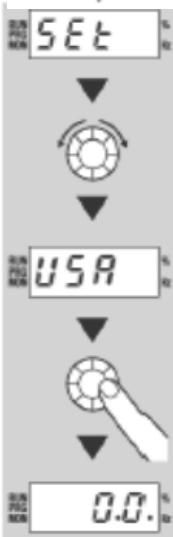
1) Quando energizamos o inversor pela primeira vez, o parâmetro **P.S.E.L.** aparece piscando no Display:
