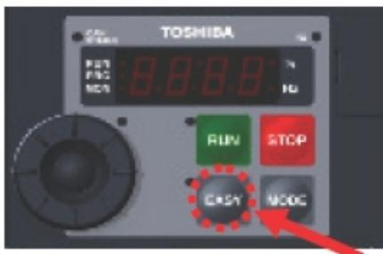
A tecla EASY provê facilidade, segurança e agilidade na programação. Após fazer a configuração inicial, você pode apertar a tecla EASY e programar o parâmetro P.S.E.L. para o valor "1" assim você só terá acesso aos principais parâmetros do inversor E.U.D., F.U.D., A.C.E., d.E.L., U.L., L.L., E.H.r., F.P., F.10 I, P.S.E.L. Para excluir ou adicionar parâmetros a essa lista, devemos utilizar o número de comunicação do parâmetro desejado e seta-lo no parâmetro correspondente ao seu número da lista:
