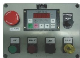
Com o painel de operação remoto você ganha tempo no start-up de sua máquina, onde com facilidade você possui as funções mais utilizadas nos inversores como potenciômetro externo, botões liga/desliga, velocidades pré-definidas, JOG, etc.
